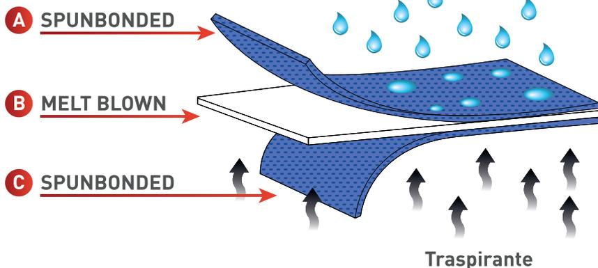
**A** Strato esterno in **Tessuto non Tessuto Spunbonded** idrofobo e antibatterico da 25 g/m<sup>2</sup> 100% polipropilene;
